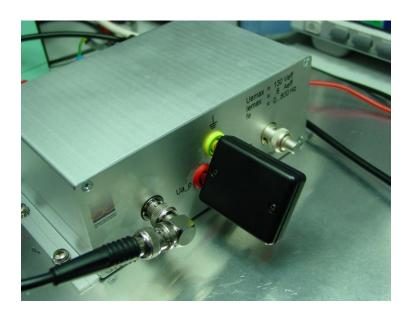
Mit Hilfe eines Signalgenerators lernen die Teilnehmer die Wirkungsweise und den Einfluß der Netznachbildung kennen. Außerdem wird die Korrelation eines Signals im Zeit- und Frequenzbereich veranschaulicht.
